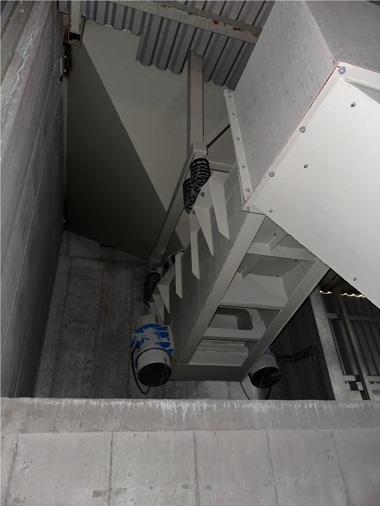
Tippkasse bunn. Tippkasse for tipp lastebil 15m3. Vibrasjonsmater for elevator
