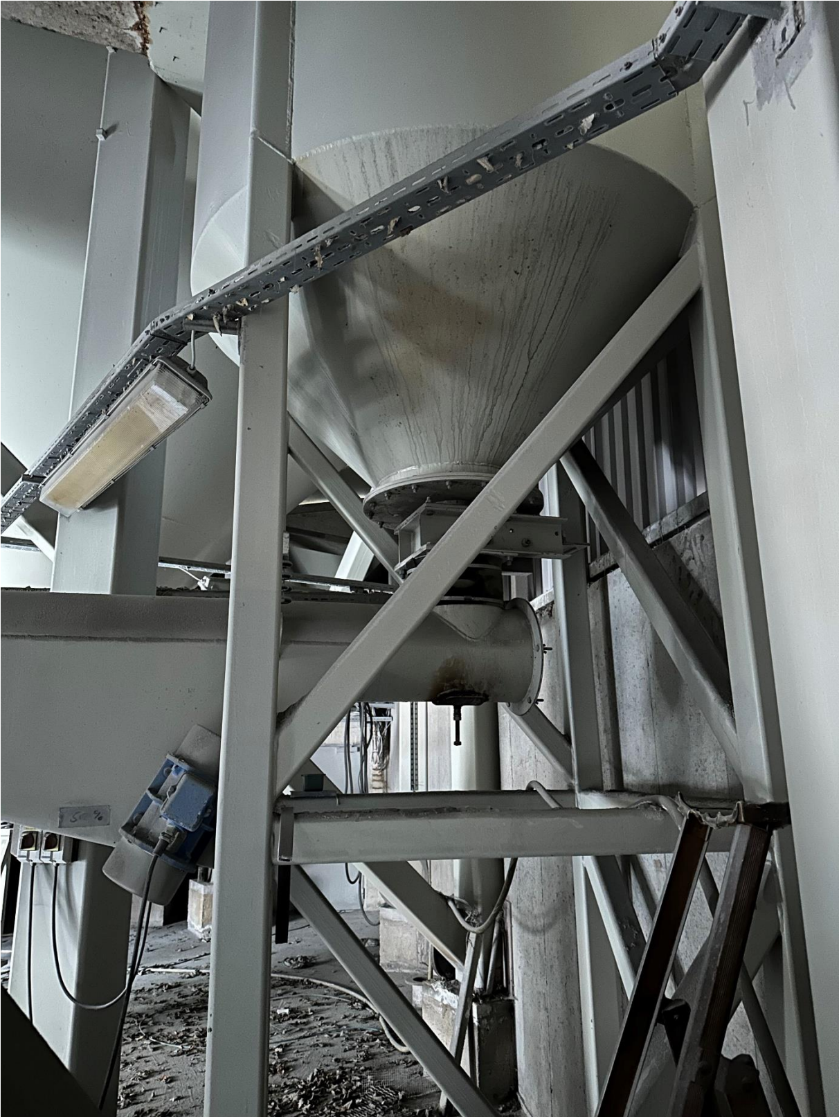
”Sigaren”. Minste silo. Med luuke og rørmater. Egne ben
