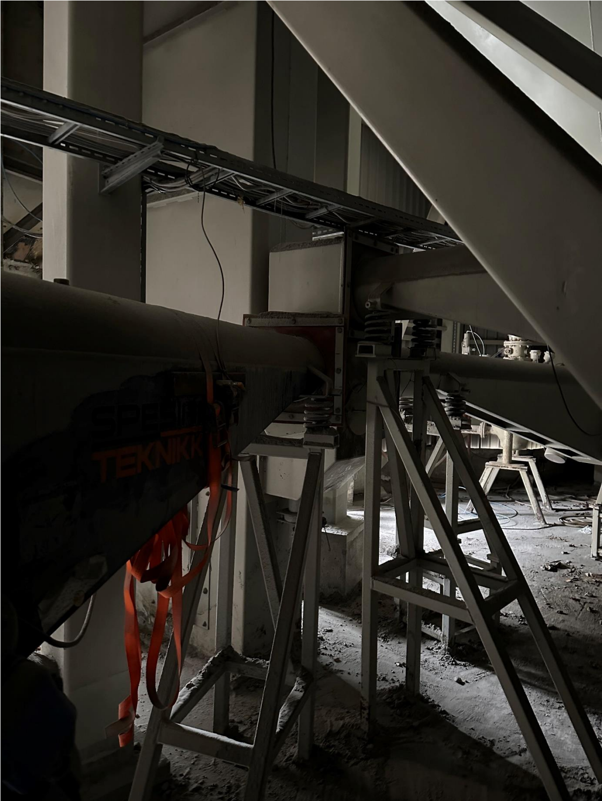
Miksepunkt mellom 3 stk siloer. Alle doseres med rørmater. Mater direkte i elevator
