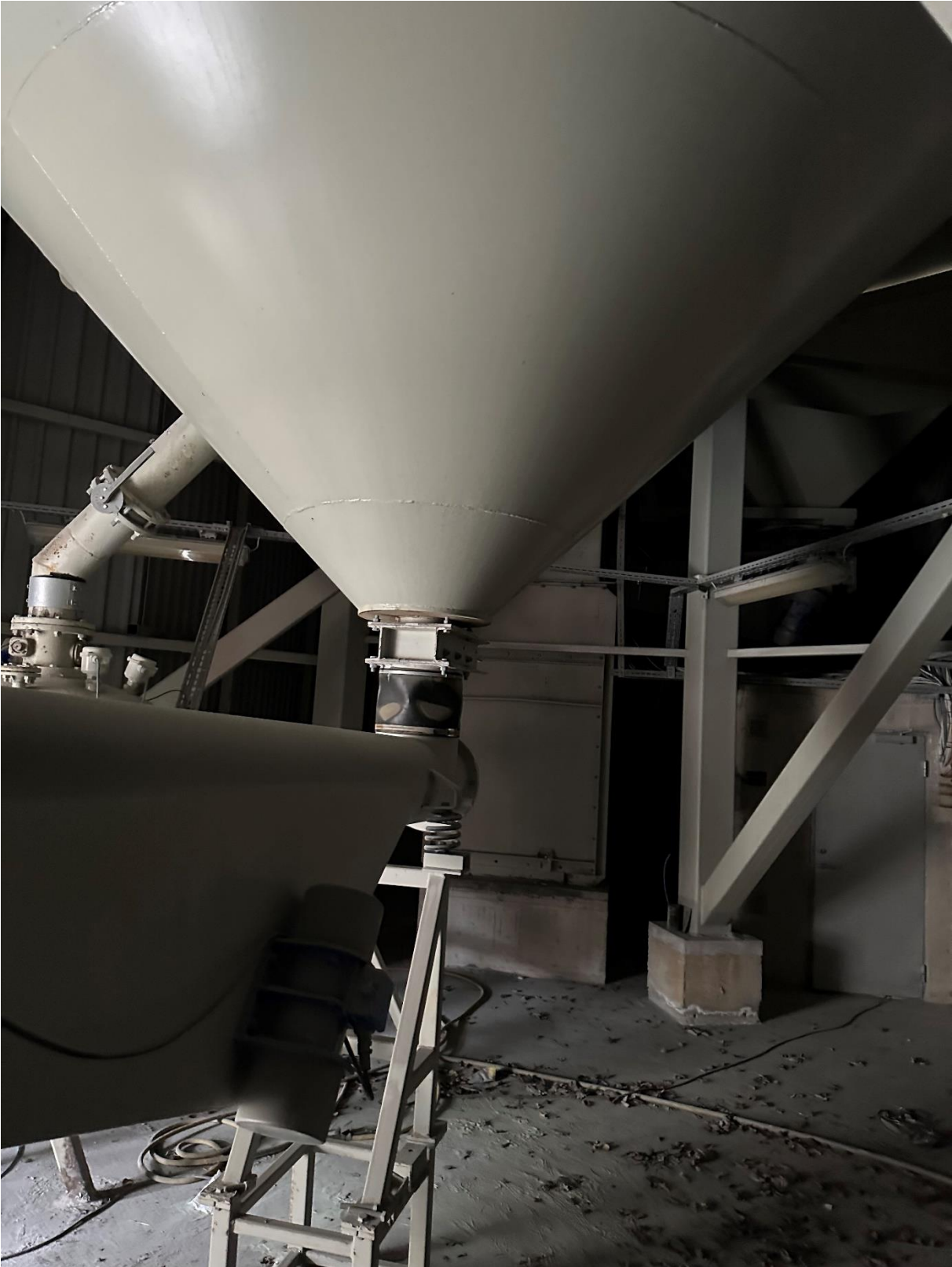
Silo med mater og utgang for blåse klokke
